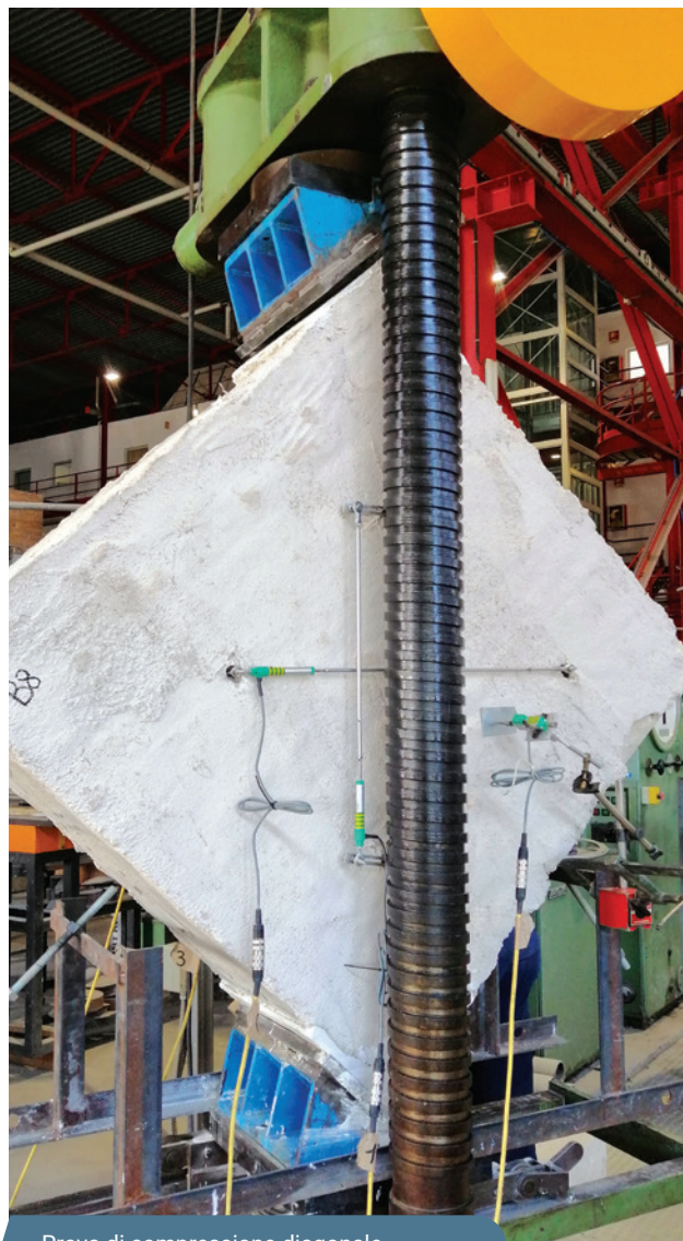
Prova di compressione diagonale.
