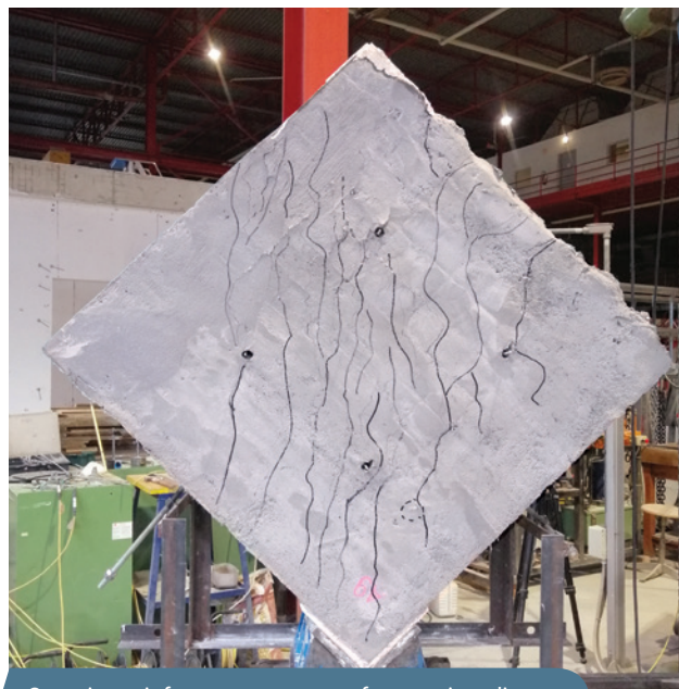
Campione rinforzato post prova: fessurazione lieve.
