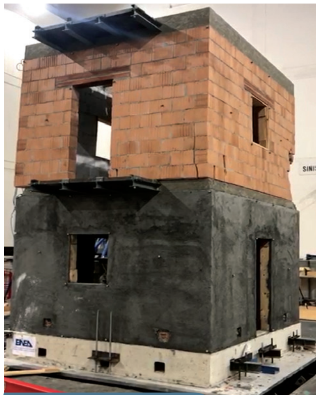
Struttura rinforzata mediante MX-PVA.
