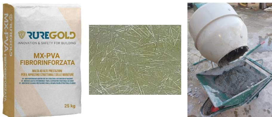
Figura 1 Malta, priva di fibre, utilizzata per la realizzazione della miscela (sinistra); fibre in PVA annegate nell'impasto (al centro); realizzazione della malta fibrorinforzata in betoniera (a destra).
