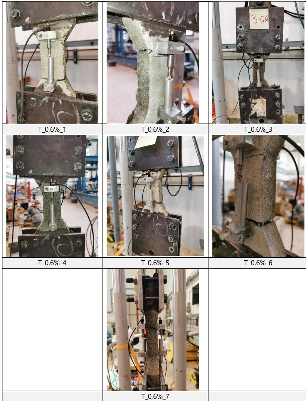
Figura 8 Resoconto fotografico. Rottura a trazione dei provini.
