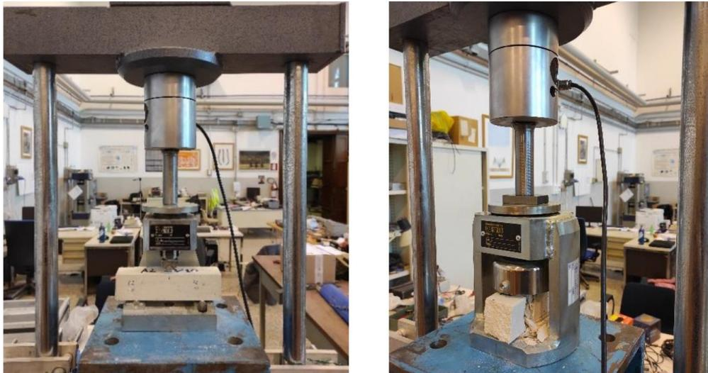
Figura 18 Prova su prismi di malta 40x40x160 mm. Flessione (a sinistra), compressione (a destra).
