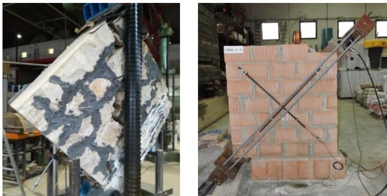
Figura 35 Prova di compressione diagonale su muratura in pietra (a sinistra) e su muratura in laterizio forato (a destra) utilizzate per la calibrazione del modello numerico.
