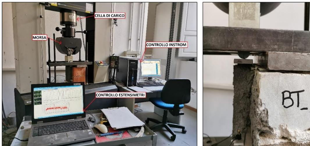
Figura 10 Schematizzazione e setup delle prove di distacco.
