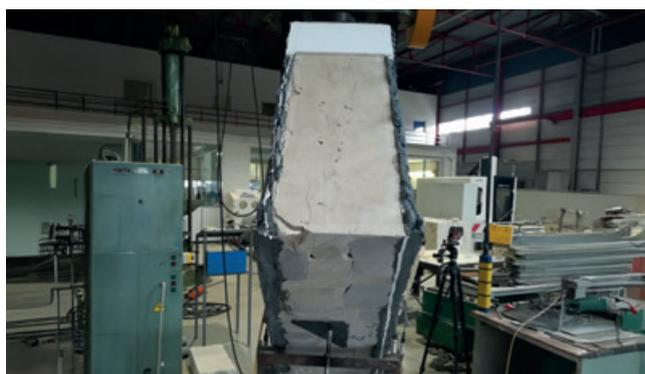
Sono state condotte prove di **compressione diagonale**, con applicazione della forza di compressione lungo una diagonale del pannello murario quadrato, lasciando l'altra diagonale scarica.
