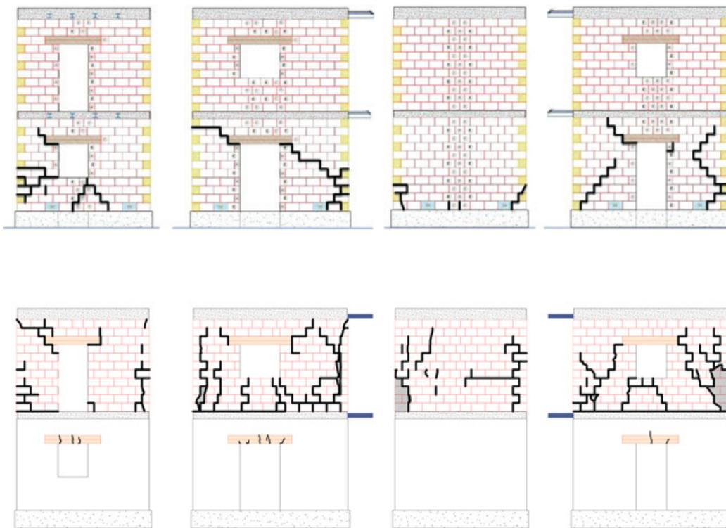
corrispondenza del fattore di scala 1.00 localizzato esclusivamente al piano inferiore della struttura e dovuto all'effetto combinato dell'azione sismica verticale e orizzontale. Il quadro fessurativo è incrementato in corrispondenza del fattore di scala 1.20, caratterizzato da fessure diagonali a taglio.
