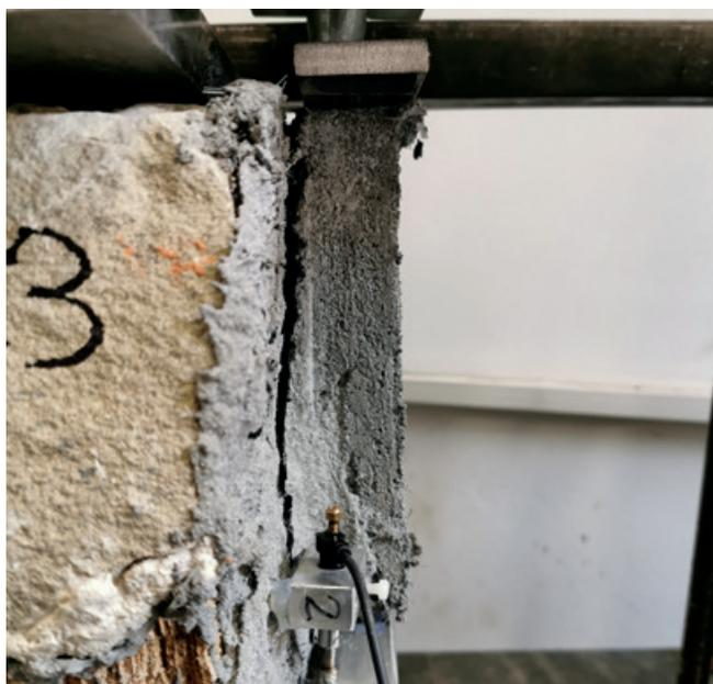
Per valutare quest'ultima capacità sono state effettuate prove di distacco dai supporti standard.
